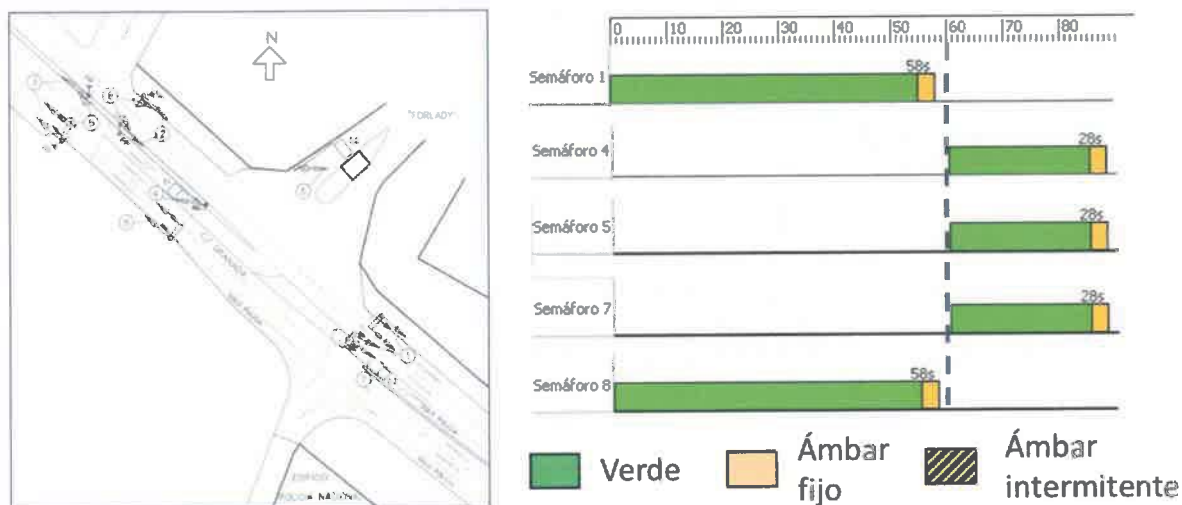
Figura 93. Esquema de la ubicación y numeración de los semáforos (izquierda) y de los nuevos ciclos propuestos (derecha)
