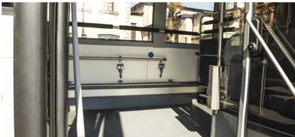
**Flujo fluido de pasajeros.** Tres puertas dobles (cuatro en el modelo articulado), el suelo bajo y la función de inclinación garantizan la entrada y la salida rápida y eficiente de los pasajeros. La rampa de embarque opcional accionada eléctricamente es una solución cómoda que aporta más ventajas a los pasajeros con problemas de movilidad.
